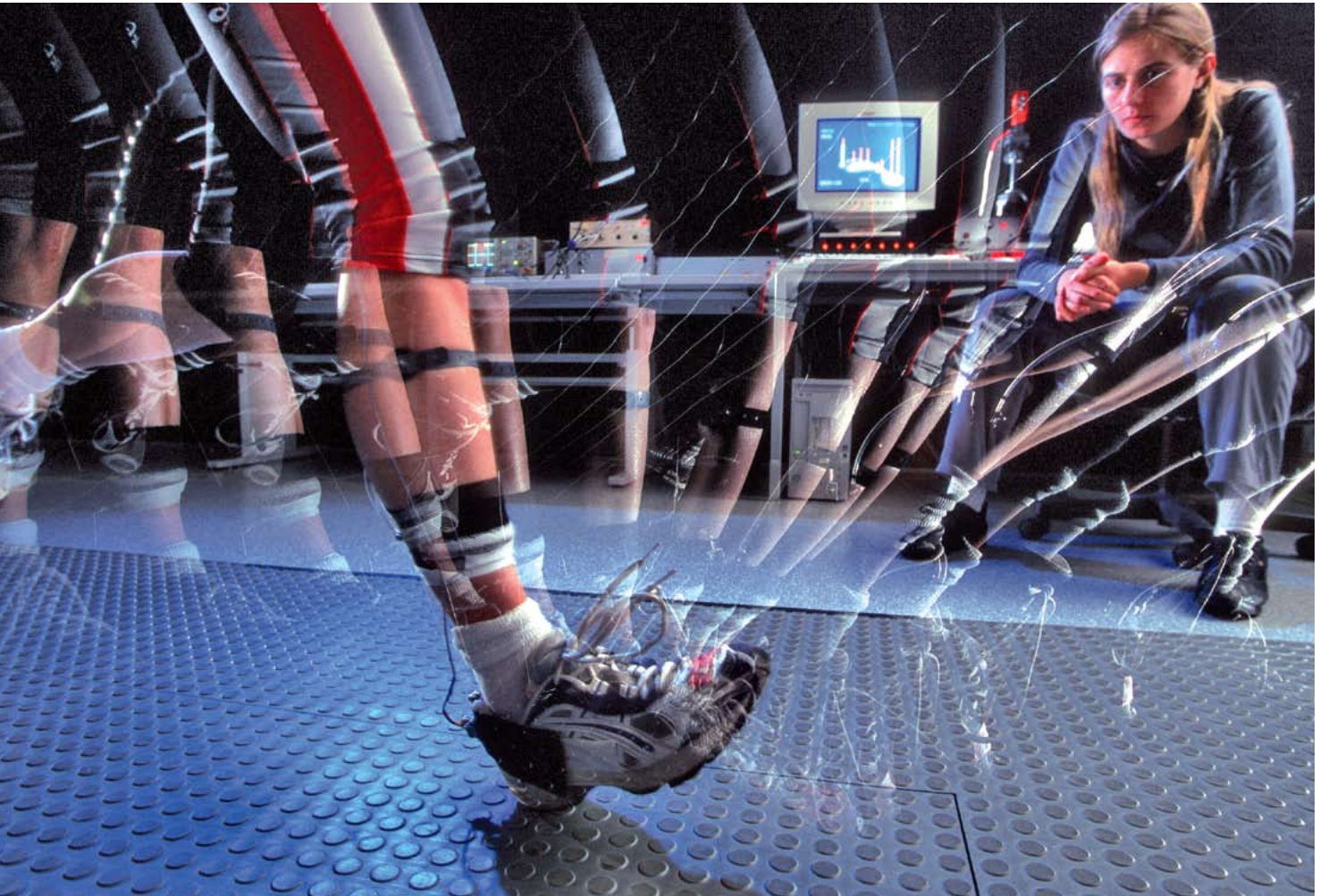
Test von Jogging shoes in einem Labor von Stiftung Warentest: Eine Kraftmessplattform misst das Dämpfungsverhalten des Schuhs, Lichtschranken messen die Laufgeschwindigkeit.
