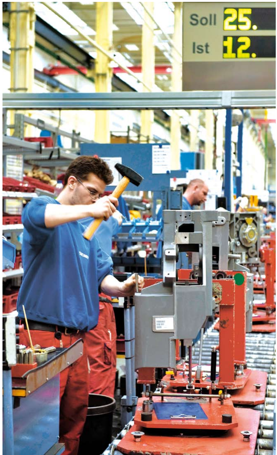
Klare Ansage: Display zum Arbeitsfortschritt (oben re. im Bild) bei der Siemens AG, Berlin.
