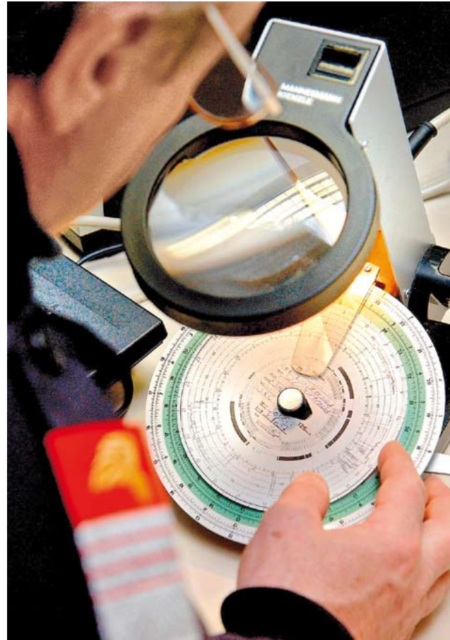
Kontrolle statt Vertrauen: Auswertung eines Lkw-Fahrtenschreibers mit einem speziellen Lesegerät.
