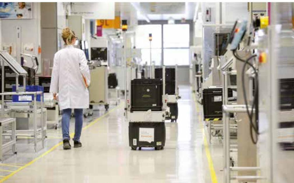
Autonom fahrende Transportroboter bringen Materialien schnell und effizient zur jeweiligen Produktionslinie.
