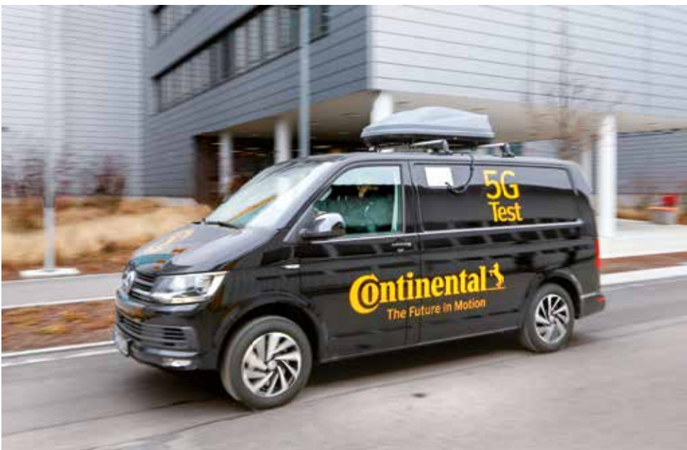
Ein mit vielfältigen Messsystemen ausgestatteter Messbus wird für Feldversuche der 5G-Funktionen von Antennenmodulen genutzt.
